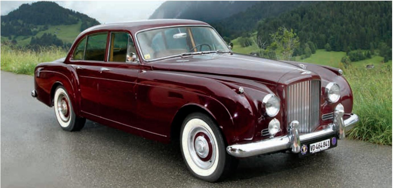
Cette Bentley Continental S2 est habillée de l'élégante carrosserie quatre portes Flying Spur en aluminium dessinée par H. J. Mulliner et fait partie des 54 à être équipée de la conduite à gauche sur les 125 construites dans ce style sur le châssis S2.
