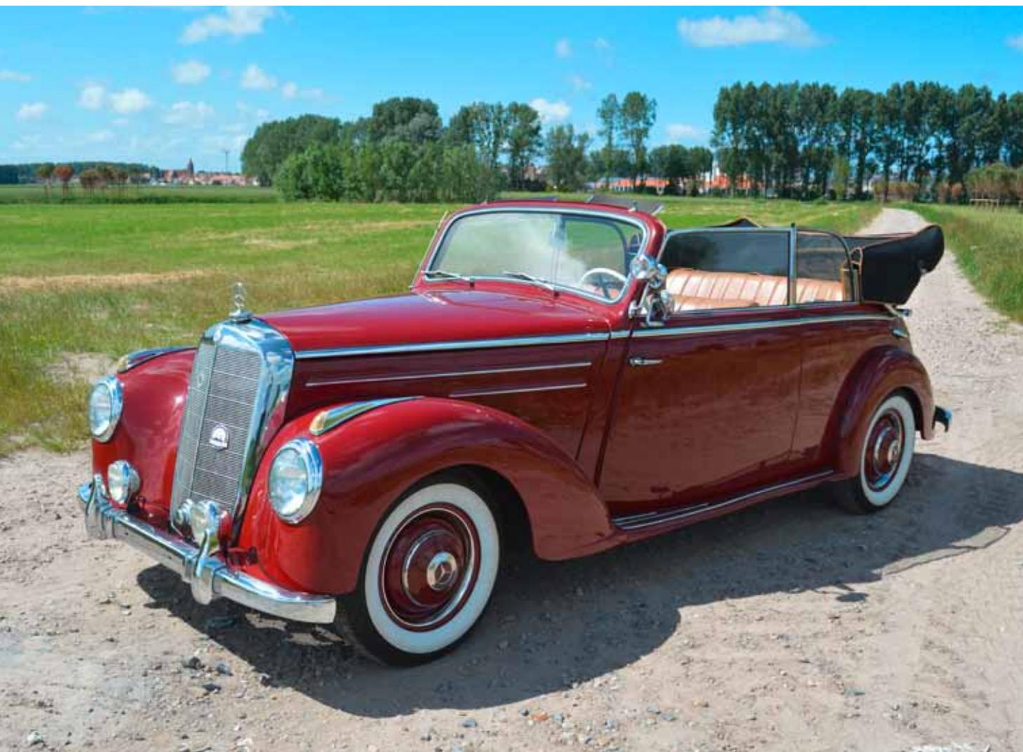
Die Leistung von 80PS des 2,2-Liter Motor, mit einer obenliegenden Nockenwellen, ermöglicht der 220 er Limousine eine Höchstgeschwindigkeit von 140km/h - genauso wie das viertürige Cabriolet B. Wohingegen das Coupé 145km/h erreicht – ähnlich das zweitürige Cabriolet A. Beide Cabriolet Modelle waren in bester Mercedes-Benz Tradition, außergewöhnlich gut ausgestattet. Die Gesamtproduktion von Cabriolet A und B lag bei nur 2.360 in fünf Jahren und beide Modelle sind heute höchst begehrt.
