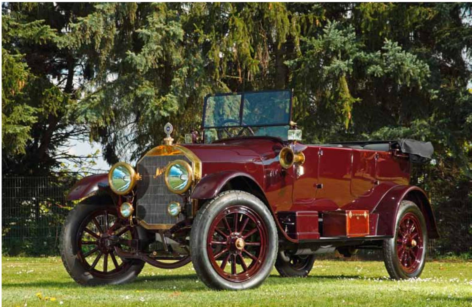
Chassisnummer 17 759 hat seine originalen Spezifikationen behalten, verfügt jedoch bereits über einen Kardanwellen-Antrieb. (Die ersten Modelle waren noch mit Kettenantrieb ausgerüstet). 1905, beim 2,6 Liter 15/20HP erstmalig verbaut, wurde die Kardanwelle bald von nahezu allen Mercedes-Fahrzeugen übernommen. Lediglich die grösseren Modelle behielten noch für eine gewisse Zeit den Kettenantrieb.
