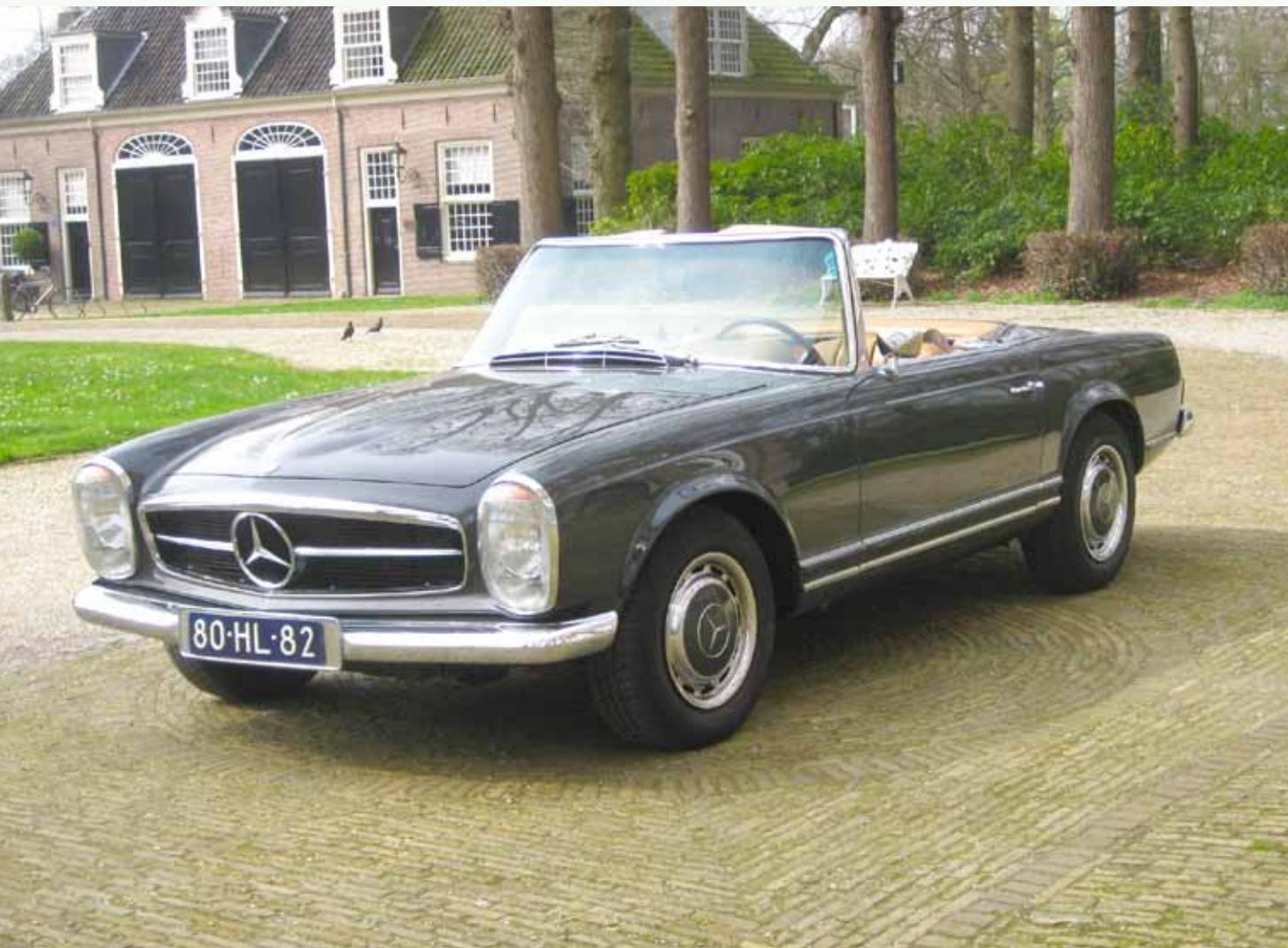
Der 280 SL wurde 1967 als letzte Inkarnation der mit dem 230 SL im Jahre 1963 vorgestellten Pagoden-Baureihe präsentiert. Sein 2,8 Liter großer Reihensechszylinder leistete 170 PS, 20 PS mehr als sein Vorgänger, der 250 SL. Die Höchstgeschwindigkeit blieb bei 200 km/h, aber er beschleunigte deutlich schneller. Nach dem charakteristischen ‚Pagodendach‘ benannt gehörten diese Mercedes-Benz SL zu den beliebtesten Reisesportwagen ihrer Zeit und sind heute überaus gesucht.
