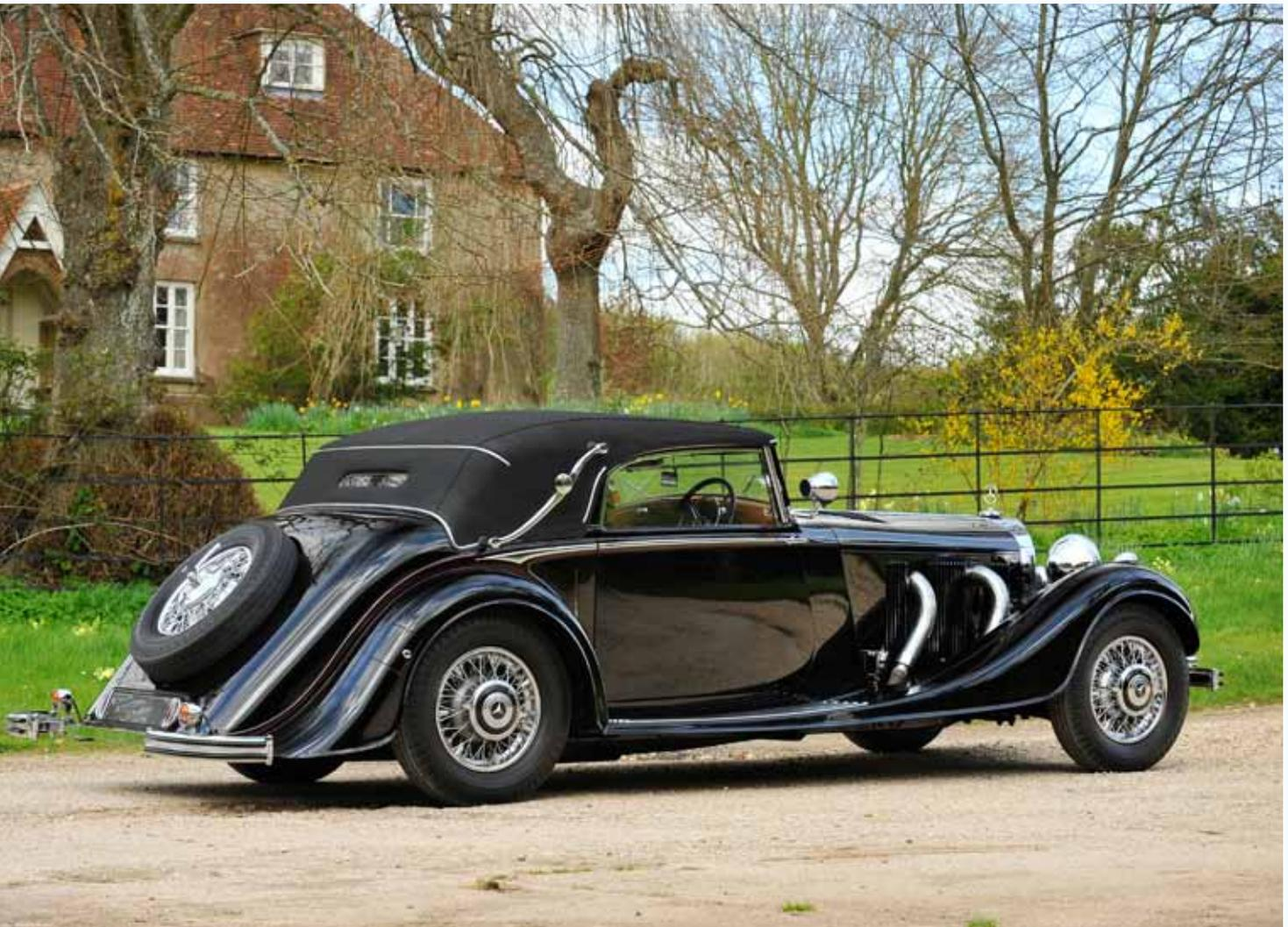
Zusammen mit seinem Nachfolger 540 K war der 500 K wohl das aufsehenerregendste Modell der Stuttgarter Firma in den 1930er Jahren. Der 500 K wird von einem 5.018 cm<sup>3</sup> Kompressor-Achtzylinder-Reihenmotor angetrieben. Es handelt sich um das Triebwerk mit dem bekannten Roots-Kompressor, bei dem durch das Durchtreten des Gaspedals gleichzeitig der Kompressor eingeschaltet und die Luftzufuhr zum Vergaser unterbrochen wird.
