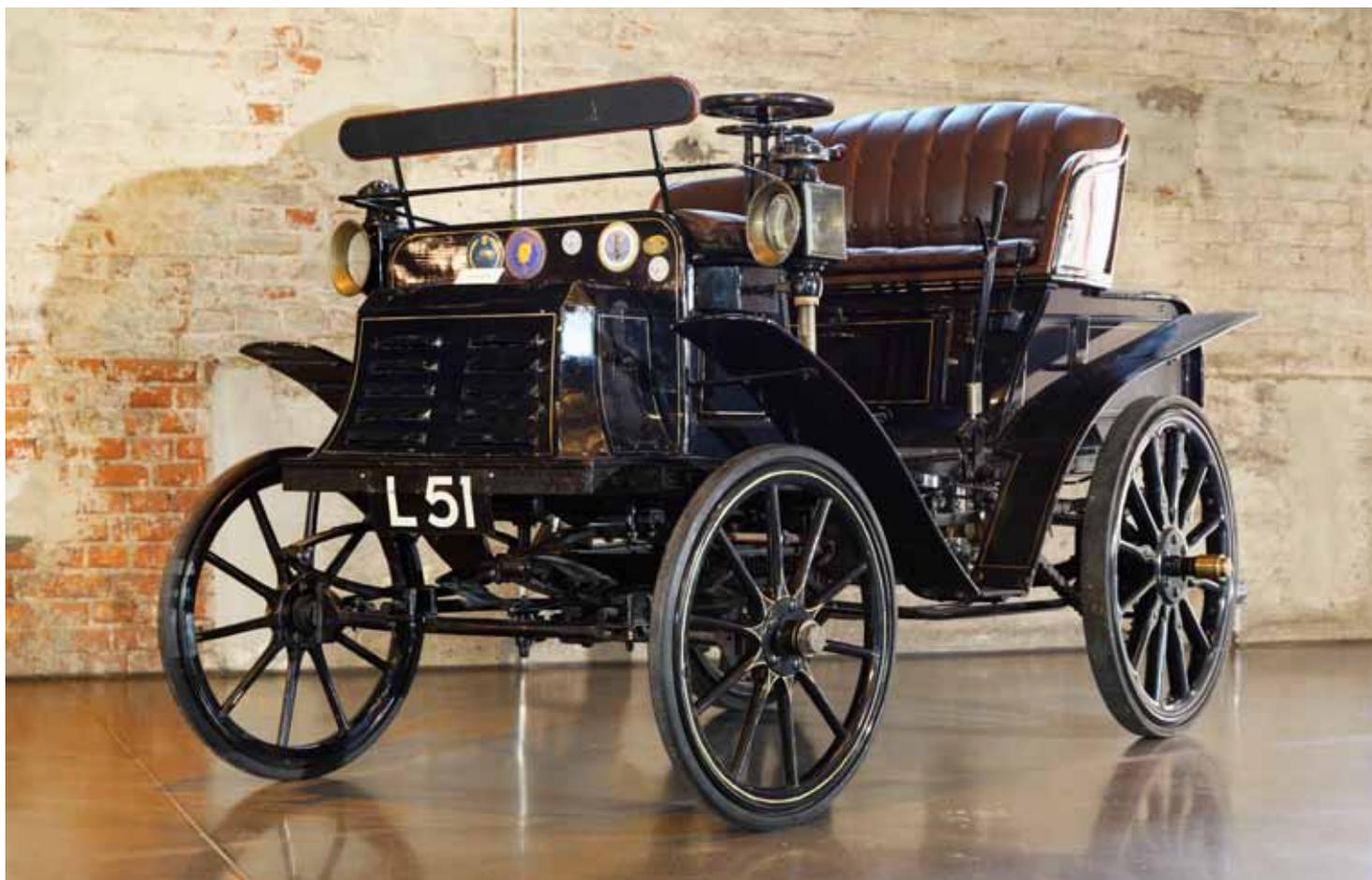
Die Benz "Contra-Motoren" Modelle werden unter Sammlern, trotz der veralteten Bauart, sehr hoch geschätzt. Aufgrund ihres modernen "Boxer-Motors" sind diese Modelle ein motortechnisches Statement ihrer Zeit.
